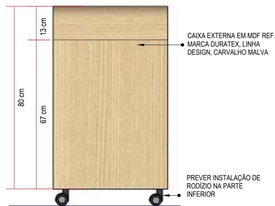
ELEVAÇÃO LATERAL - MODELO 1 - VISTA 02 escala 1:10
